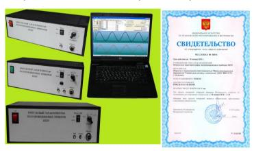
В состав измерителя теплового сопротивления входит ИМПУЛЬСНЫЙ характериограф полупроводниковых приборов ИХПП (№70158-18 в Госреестре), компьютер и программное обеспечение, реализующее методы измерения теплового сопротивления, изложенные в ОСТ 110944-96 «Микросхемы интегральные и приборы полупроводниковые. Методы расчета. измерения контроля теплового И сопротивления».
